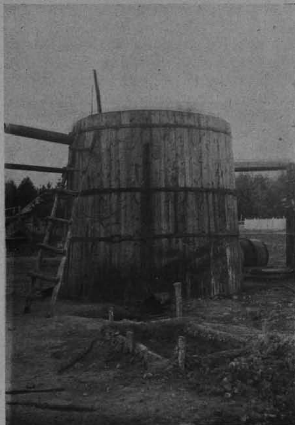
Ryc. 51 Fot. A. Chomicz Chłodnica, w której skraplają się pary terpentyny i wody.
